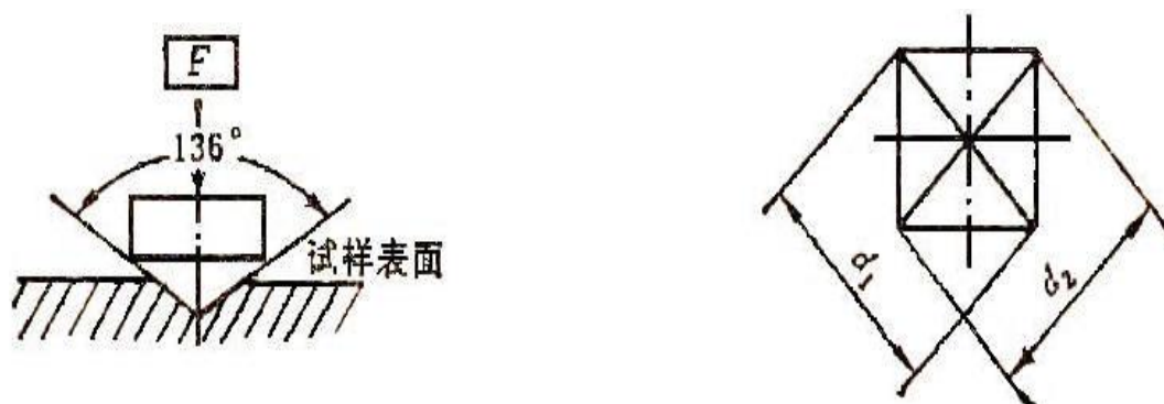
图 6 维氏硬度试验原理图
